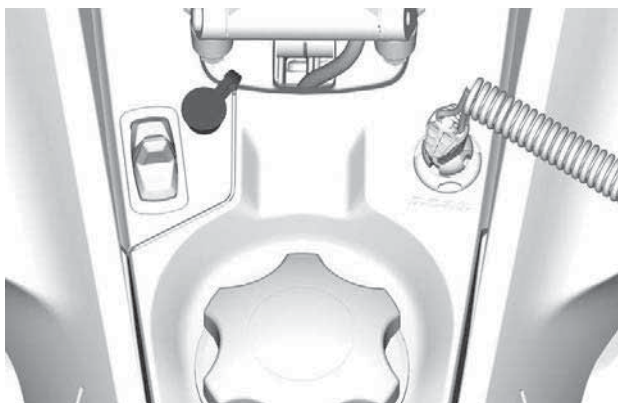
KULJETTAJAN SÄHKÖISEN VISIIRIN JAKKILIITTIMEN SIJAINTI
