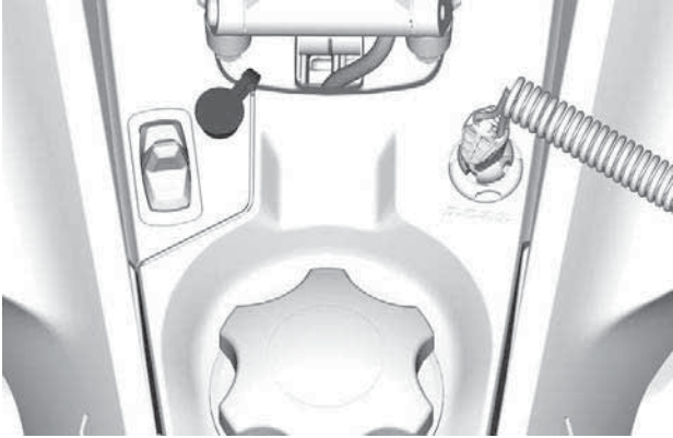
FAHRER - LAGE DER ANSCHLUSSBUCHSE FÜR ELEKT- RISCH BEHEIZBARES VISIER
