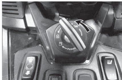
ПОЛОЖЕНИЯ КЛЮЧА ДЛЯ ОТКРЫТИЯ ПЕРЕДНЕГО БАГАЖНОГО ОТСЕКА
