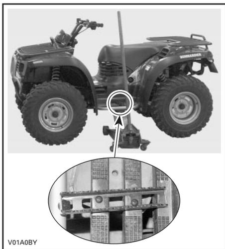
Au moment de remettre la roue en place, on recommande d'appliquer un lubrifiant antigrippage sur les filetages. Serrer les écrous progressivement, en ordre entrecroisé, puis exercer un couple final de 75 N•m (55 lb•pi).
