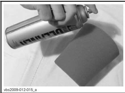
TYPEBILDE – SPRAY SKUMFILTERELEMENTET INNVEDIG OG UTVENDIG
