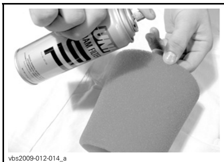
TYPEBILDE – OLJE PÅ SKUMFILTERELEMENET
