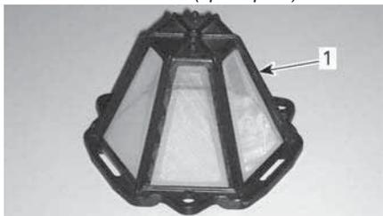
1. Filtro dell'aria CVT (tipo clip-on)
