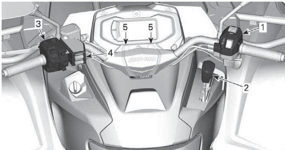
1. Alloggiamento del comando della leva dell'acceleratore
