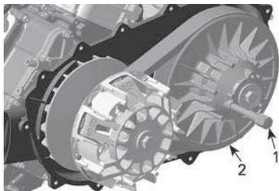
1. Strumento di traino/bloccaggio
