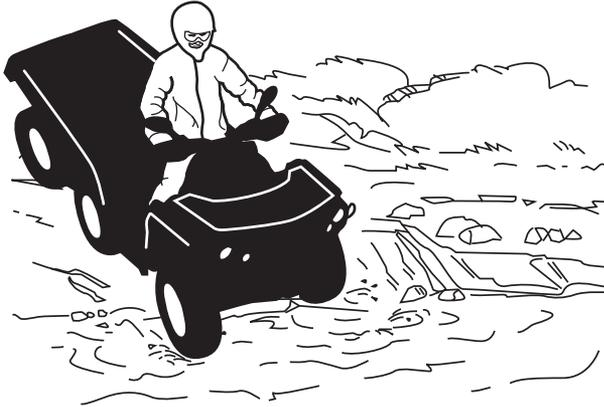
I freni bagnati compromettono la capacità di frenata del veicolo. Accertarsi che i freni siano asciutti frenando diverse volte dopo essere usciti da acqua, fango o neve. Lasciare una maggiore distanza di sicurezza per la frenata.
