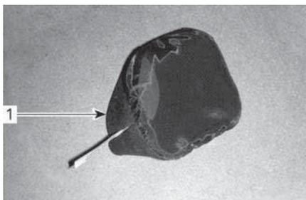
1. Filtro dell'aria CVT (tipo slip-on)
