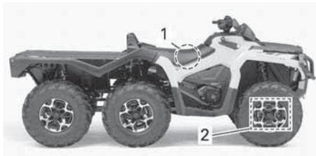
1. Etichetta VIN - Sul telaio sotto il sedile
