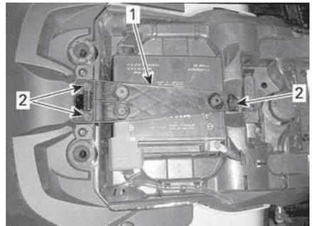
1. Fascetta di fissaggio della batteria
