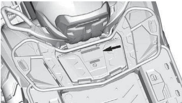
**Pictogramme d'avertissement pour l'installation du siège passager ou de la boîte à gants (véhicule à deux places)**
