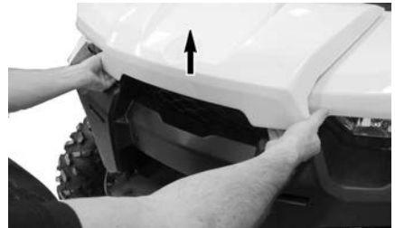
LØFT PÅ KANTEN PÅ SERVICEDEKSELET FORAN.
