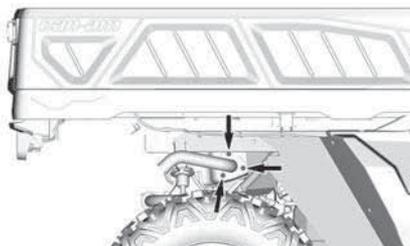
2. Rimuovere il tubo di coda di scarico, la guarnizione (eliminare) e il parascintille.
