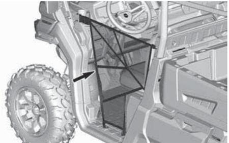
**PROTEZIONE LATERALE CONDUCENTE IN FIGURA**
