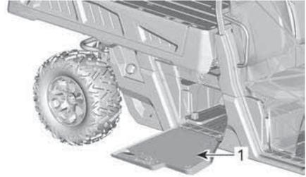
Rimuovere il coperchio della batteria svitando i due dispositivi di fissaggio di 1/4 di giro.
