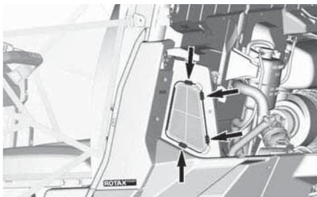
3. Rimozione del filtro dell'aria CVT.
