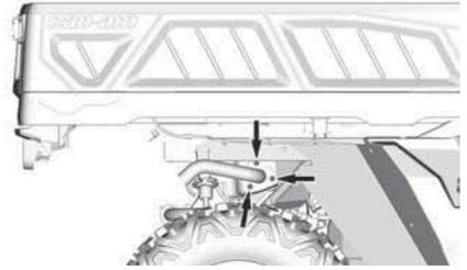
2. Retire el tubo de escape, la junta (deséchela) y el supresor del silenciador.
