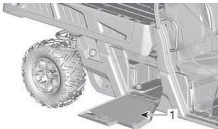
Desmonte la tapa de la batería desatornillando los dos fijadores de 1/4 de vuelta.
