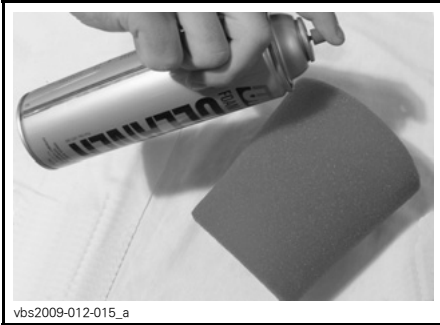
TYPISCH - BESPRÜHEN SIE DAS SCHAUMELEMENT VON INNEN UND AUßEN
