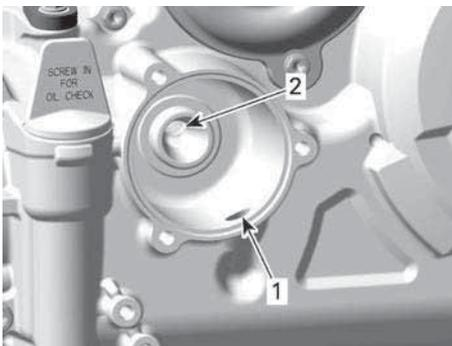
1. Einlass-Bohrung der Ölpumpe zum Ölfilter
