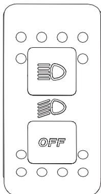
Mit diesem Schalter wird entweder die OFF-Stellung, das Ablendlicht oder das Fernlicht ausgewählt.
