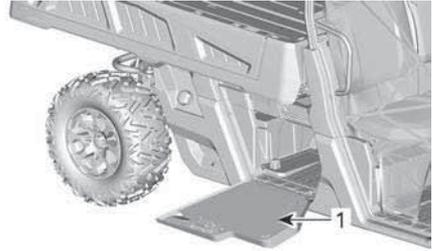
Schrauben Sie zum Entfernen der Batterieabdeckung die beiden Bajonettschlüsse ab.
