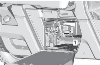
1. Hinterer Sicherungskasten
