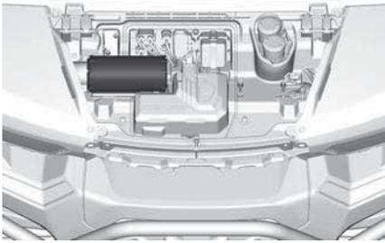
Zum Ausbauen Filter anheben und verschieben.
