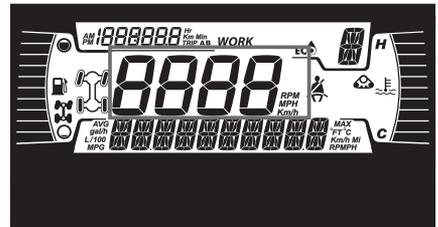
Anzeige der Fahrzeuggeschwindigkeit in km/h oder MPH.
