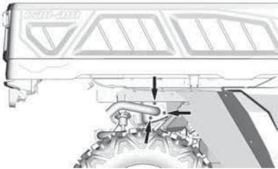
2. Entfernen Sie das Abgasrohr, die Dichtung (entsorgen) und den Funkenfänger.
