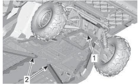
1. Hebestelle unter der Schutzplatte
