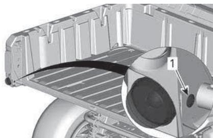
1. Винт крепления рассеивателя
