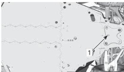
1. Область пробки сливного отверстия коробки передач
