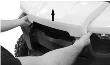
DE RAND VAN HET VOORSTE ONDERHOUDSDEKSEL OPTILLEN.
