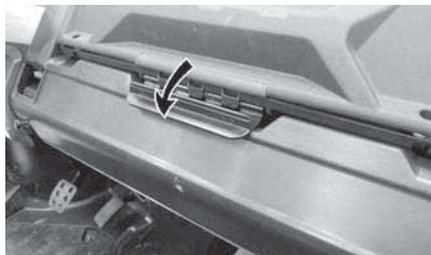
2. Чтобы закрыть крышку, опустите ее и сдвиньте фиксатор вверх.
