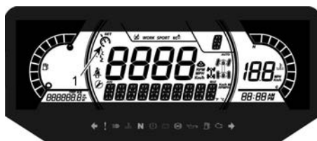
1. Indicador del limitador de velocidad
