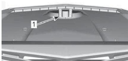
1. Установочный паз на внутренней части крышки сервисного отсека
