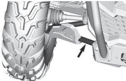
4. Зафиксируйте задние колеса, используя буксировочные стропы.
