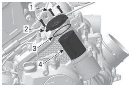
1. Винт крышки масляного фильтра
