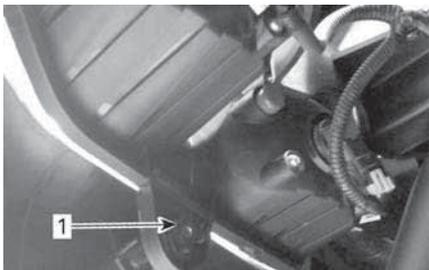
1. Регулировочный винт
