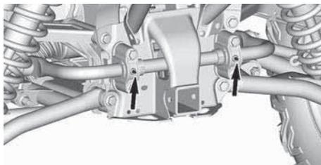
**ТИПОВОЙ ВАРИАНТ – ЗАДНИЙ СТАБИЛИЗАТОР ПОПЕРЕЧНОЙ УСТОЙЧИВОСТИ**
