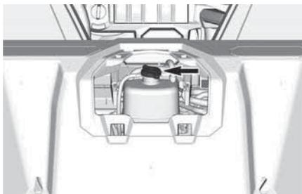
2. При необходимости добавьте в систему охлаждающую жидкость. Пользуйтесь воронкой, чтобы не расплескать жидкость. **Не переливайте.**
