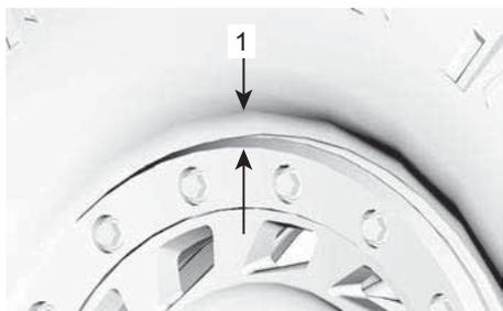
1. Одинаковый зазор вокруг фиксирующего кольца
