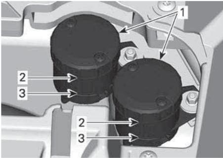
1. Бачки для тормозной жидкости
