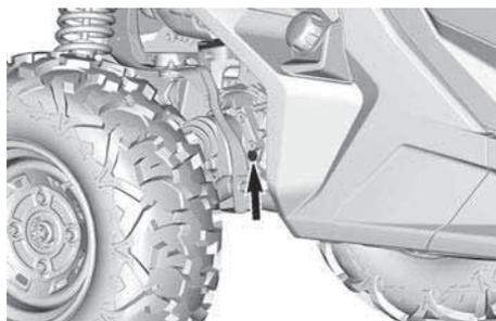
3. Выверните пробку заливного отверстия.
