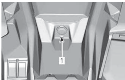
1. Электрическая розетка (12 В)
