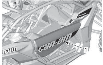
1. Porta fechada e corretamente travada
