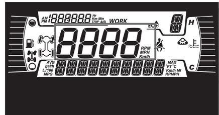
Muestra la velocidad del vehículo en km/h o MPH.
