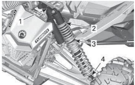
**TÍPICO - CON AMORTIGUACIÓN DE REBOTE - SUSPENSIÓN DELANTERA**
