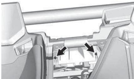
Desconecte la manguera del intercooler.
