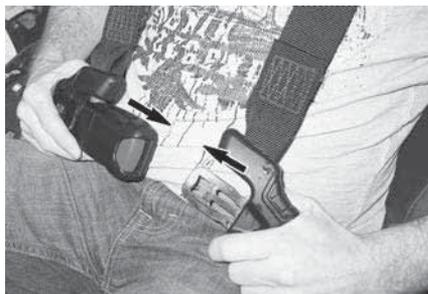
**En ambos lados,** ajuste el cinturón firmemente contra su cuerpo tirando del exceso de cinturón del regazo hacia el interior. La hebilla debe estar centrada en la cintura (lo más baja posible).
