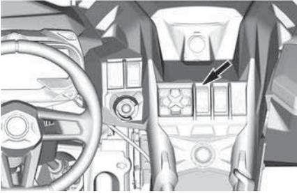
Este interruptor permite seleccionar el modo de tracción a 2 o a 4 ruedas con el vehículo parado y el motor funcionando.
