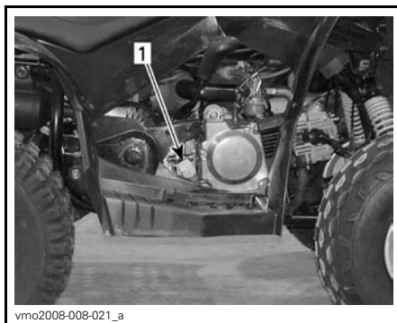
TYPBILD— HÖGER SIDA AV MOTORN 1. Oljemätsticka
