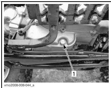
VÄNSTER SIDA AV MOTORN 1. Dräneringsplugg
