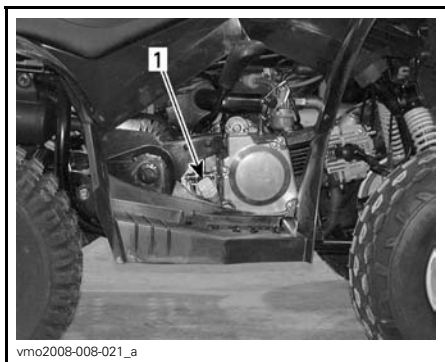
TYPBILD— HÖGER SIDA AV MOTORN 1. Oljemätsticka
