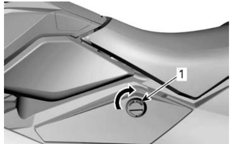
TAMPA DE ACESSO ESQUERDA
