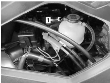
1. Tampa do tanque de expansão
