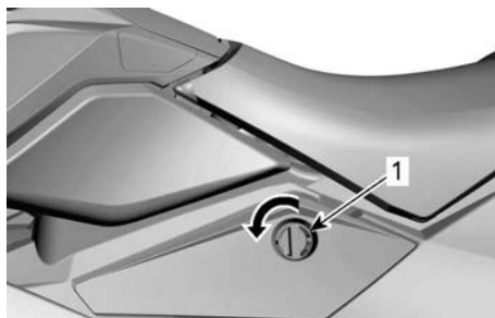
TAMPA DE ACESSO ESQUERDA
