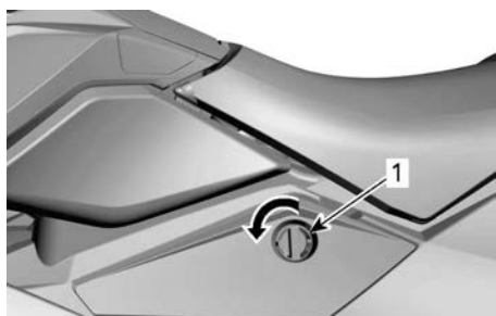
TAMPA DE ACESSO ESQUERDA
