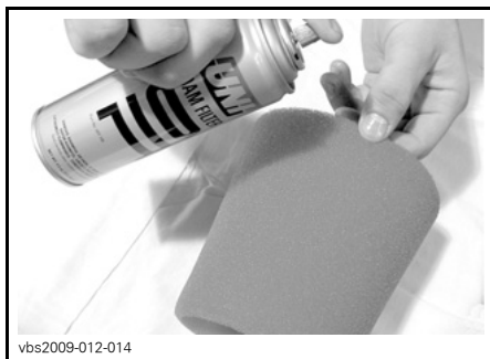
TYPISCH - FILTERELEMENT MET OLIE SMEREN
