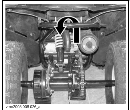
KAIKKI MALLIT — KIINNITYSKOHTA TAKANA
