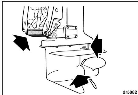
A corrosão galvânica destrói as peças metálicas submersas e pode ocorrer em água doce ou salgada; no entanto, as águas salgadas, salobras ou poluídas aceleram a corrosão.
