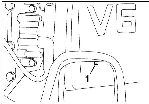
1. Porta de pressão da água (parte de trás do bloco do motor)
