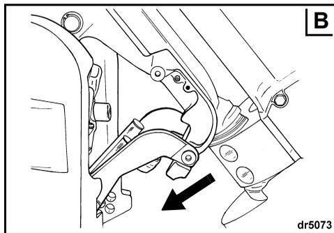
**Para desengatar o suporte** — Incline completamente o motor. Volte a colocar o suporte para reboque na posição de reboque. Baixe o motor para a posição vertical.
