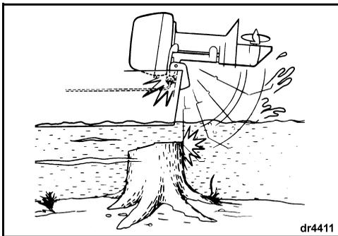
O sistema de amortecedores do motor fora de bordo não funciona em marcha-atrás. Se chocar contra um objecto, quer na água quer durante o reboque, pode danificar seriamente o barco e o motor.
