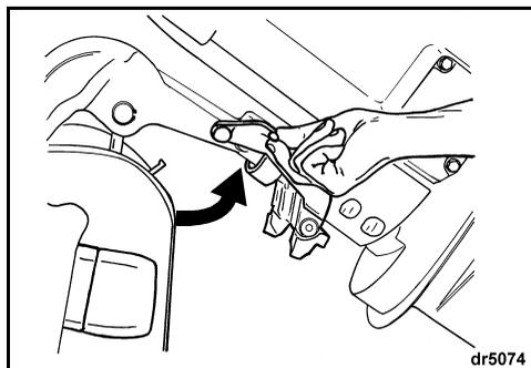
O motor foi projectado para ser rebocado na posição vertical ou inclinada, usando o suporte para reboque. Utilize a posição mais adequada para o seu barco.
