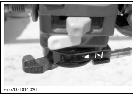
TÍPICO — ALAVANCA DO AFOGADOR NA POSIÇÃO AFOGADO
