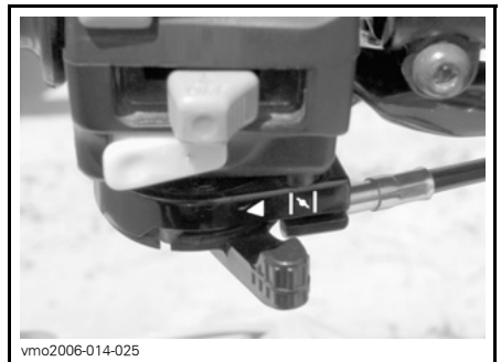
CHOKE GEÖFFNET, HEBEL IN UNBETÄTIGTER STELLUNG
