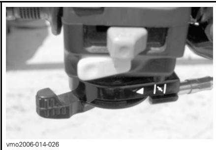
CHOKE BIS ZUM ANSCHLAG BETÄTIGT
