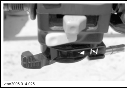
TYPISCH — CHOKE GESCHLOSSEN, HEBEL VOLLSTÄNDIG BETÄTIGT
