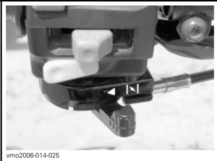
TYPISCH — CHOKE GEÖFFNET, HEBEL IN RUHESTELLUNG
