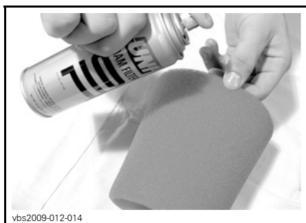
TYPISCH - SCHAUMFILTERELEMENT ÖLEN
