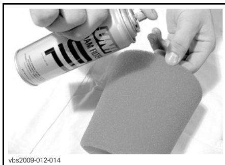
TYPEBILDE – OLJE PÅ SKUMFILTERELEMENT
