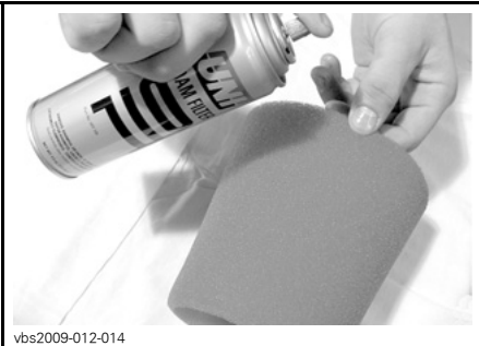
TYPISCH - FILTERELEMENT MET OLIE SMEREN
