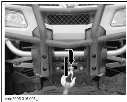
ALLE MODELLEN BEHALVE 800R X XC TYPISCH - BEVESTIGINGSPUNT VOORAAN
