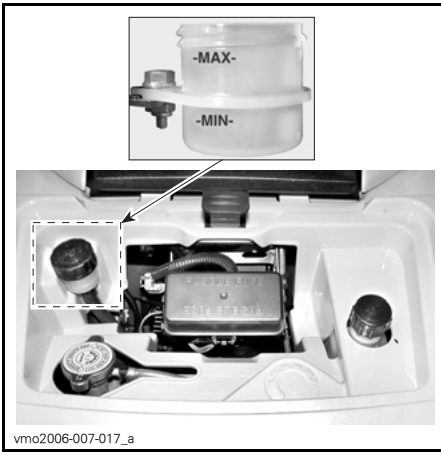
TYPISCH - VLOEISTOFRESERVOIR VAN HET REMPEDAAL
