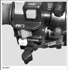
CHOKE LEVER IN THE FULL CHOKE POSITION
