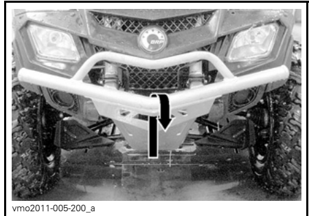
800R X XC MODELLE TYPISCH - VORDERER VERZURRPUNKT
