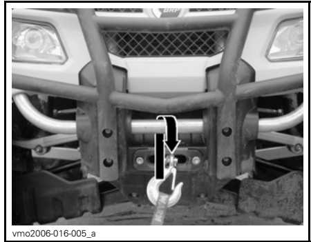
ALLE MODELLE AUßER 800R X XC TYPISCH - VORDERER VERZURRPUNKT
