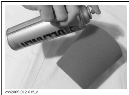
TYPISCH - BESPRÜHEN SIE DAS SCHAUMSTOFFFILTERELEMENT
