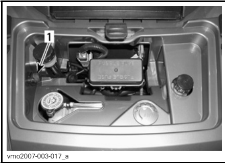
vmo2007-003-017_a VORDERES SERVICEFACH 1. Anschluss für Fernsteuerung
