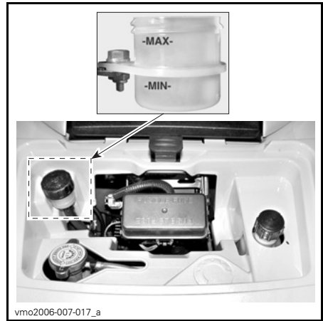
TYPISCH - BEHÄLTER FÜR BREMSFLÜSSIGKEIT DES BREMSPEDALS
