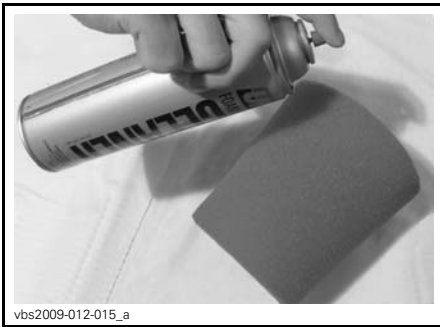
TYPIQUE - IMPRÉGNER L'ÉLÉMENT EN MOUSSE
